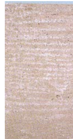
Sciage sur calcaire de Portland
