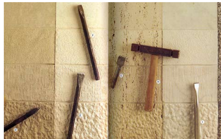
Répertoire des outils de taille et de leur empreinte sur le calcaire et le grès :
